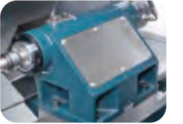
● 穩重的底座為箱型結構設計，高速加工穩定性優良。
