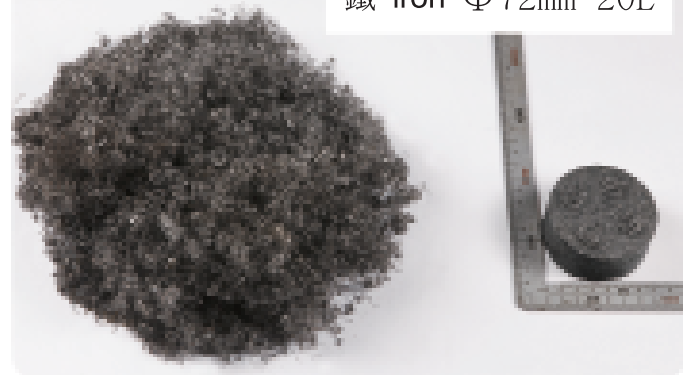
鐵 iron \Phi 72\text{mm} * 20\text{L}
