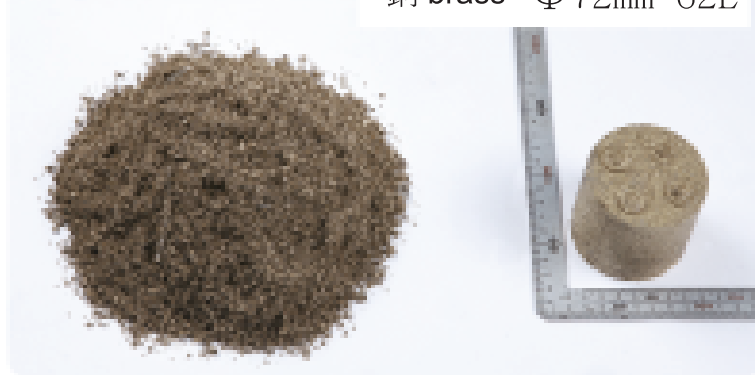
銅 brass \Phi 72\text{mm} * 62\text{L}
